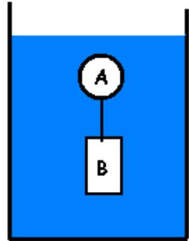
19. Um recipiente, de forma cilíndrica, vazio, flutua em água com 6 cm da sua altura acima da superfície da água. A base do recipiente tem a área de  $50 \text{ cm}^2$  e tem um bloco de chumbo ( $d=11.2$ ) de 560 g, preso ao meio. O bloco é colocado dentro da lata. Determine a altura que fica agora acima da superfície da água.
