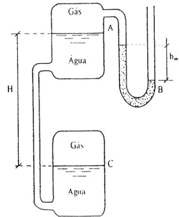
3. No reservatório de água da figura, que tem a superfície livre à pressão atmosférica normal, mergulham os extremos de um tubo em U cheio de água
