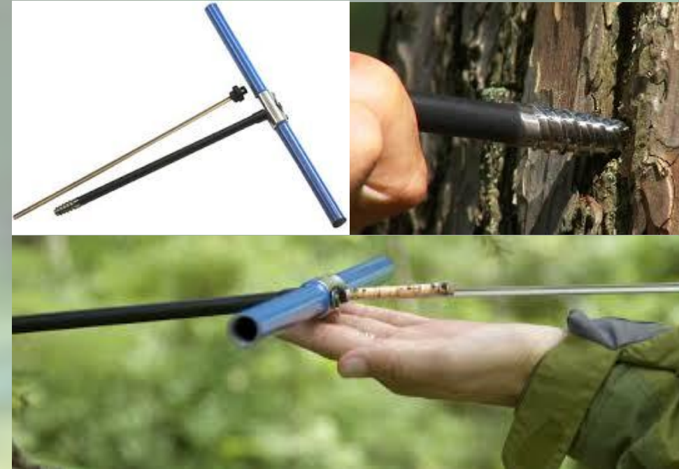
Exemplos de uma verruma e da extração de uma verrumada
