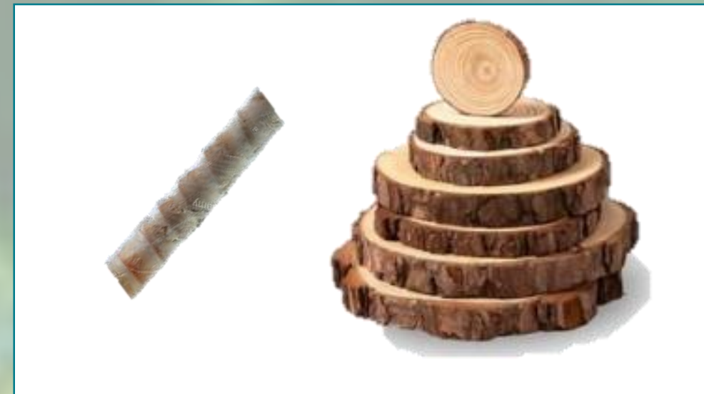
Exemplo de uma verrumada e de um conjunto de discos para análise de tronco
