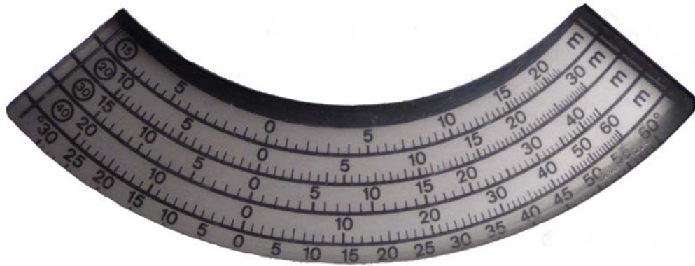
Figura 2 – Escalas do hipsómetro de Blum-Leiss.
