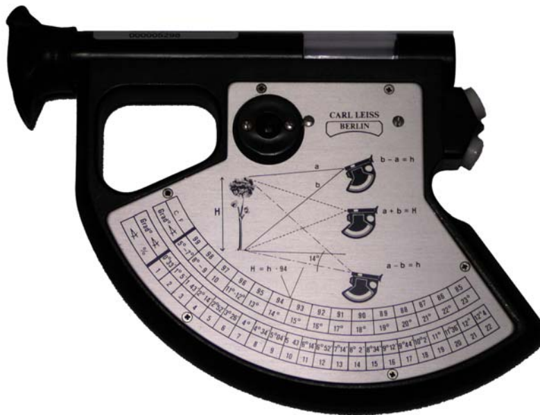
Figura 8 – Face do hipsómetro de Blum-Leiss contendo a tabela com o factor de correcção da altura consoante o declive do terreno.
