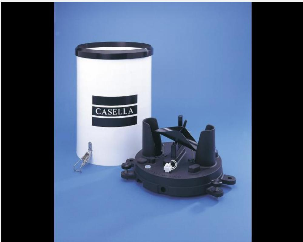
Um udógrafo basculante é um tipo de pluviômetro utilizado para medir a quantidade de precipitação. Ele é especialmente útil para registrar dados de chuva de forma contínua e precisa.
