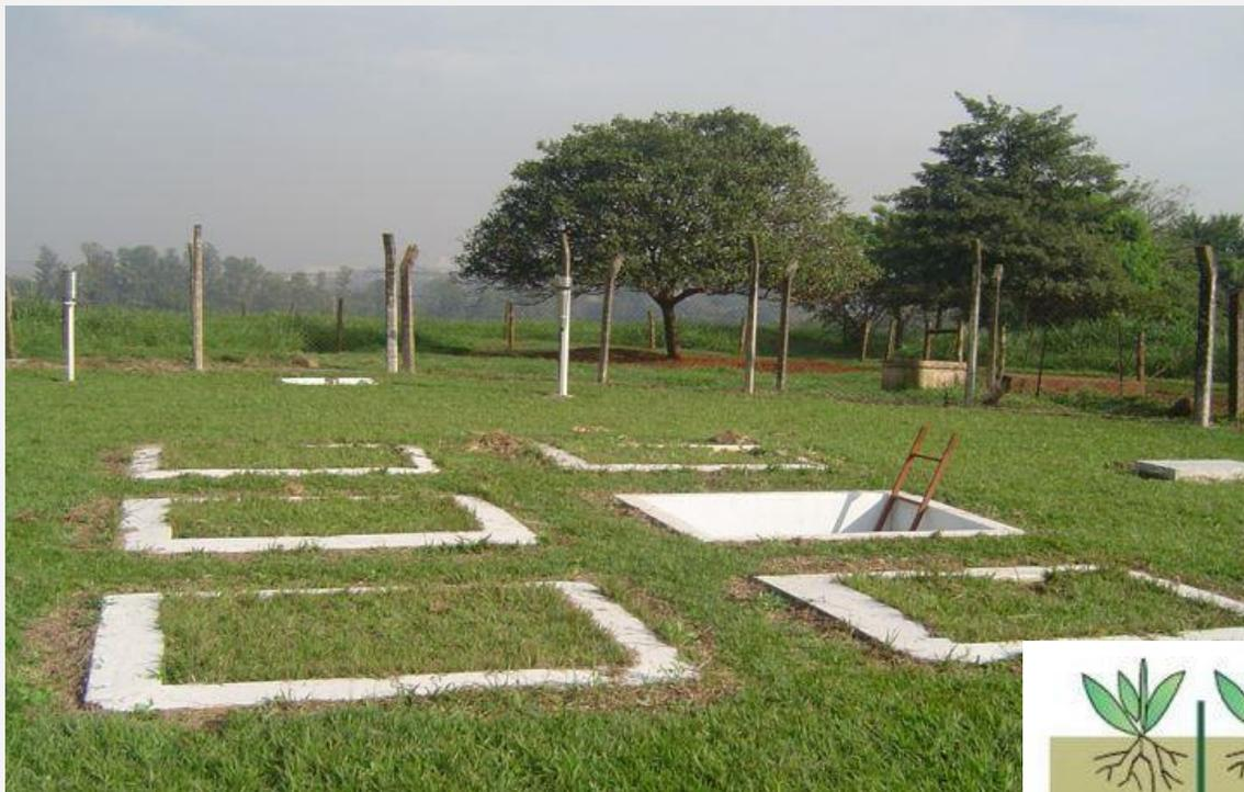
Um **lisímetro** é um instrumento utilizado para medir diretamente a **evapotranspiração** (ET) de uma superfície de solo, sendo uma ferramenta importante em estudos hidrológicos, de irrigação, gestão de água e agricultura. Ele funciona capturando e quantificando o movimento da água no solo, incluindo a quantidade de água que evapora e a quantidade de água transpirada pelas plantas.
