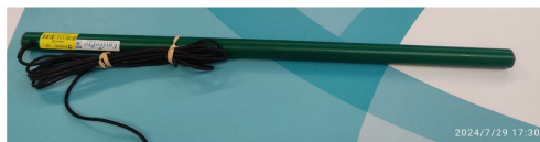
Figura 14 - Sonda EnviroPro® antes da instalação (foto pelo autor).
