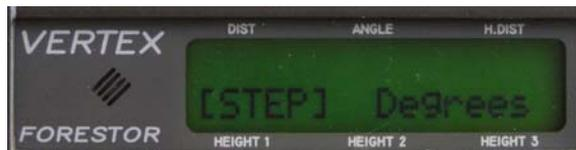
**AVISO:** Quando o aparelho está configurado para realizar medições angulares em percentagem, se forem medidos valores superiores a 100%, ele muda automaticamente para grados.
