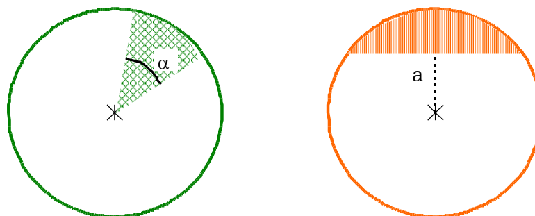
Figura 81 Exemplos de partições de parcelas de acordo com as proporções dos estratos: sector circular à esquerda e parte de um semi-círculo à direita.
