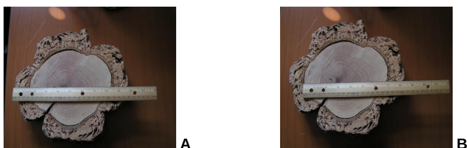
Figura 25. Medição de diâmetro com (A) e sem (B) casca, respectivamente
