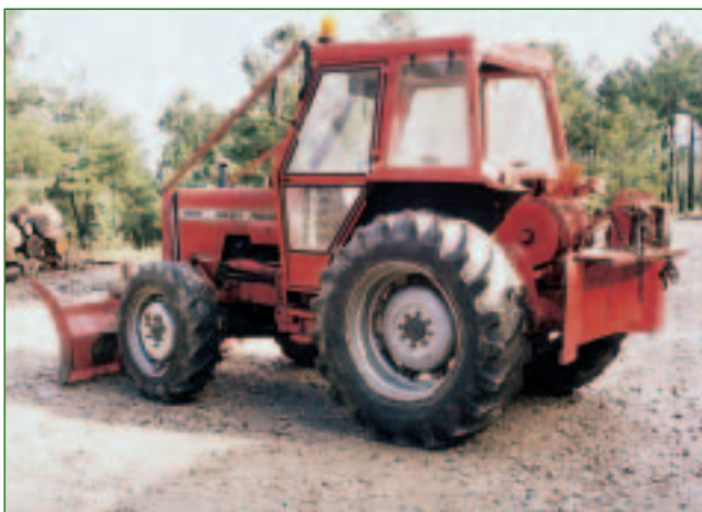
Figura 31 – Tractor agrícola adaptado ao trabalho florestal com guincho e lâmina frontal
