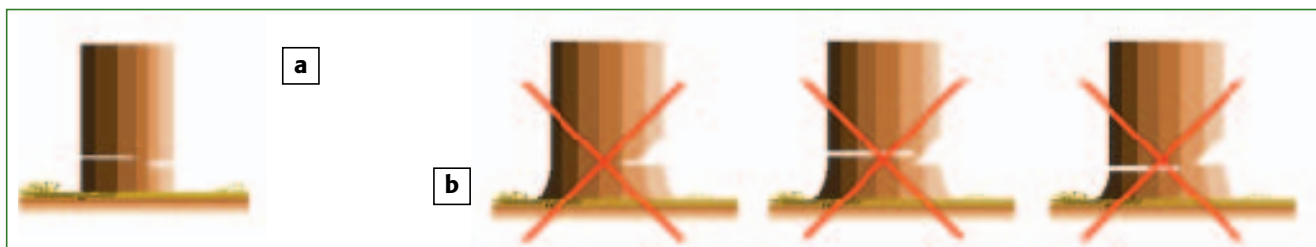
Figura 7 – a) Abate em árvores de pequena diâmetro b) Procedimentos incorrectos no abate de uma árvore
