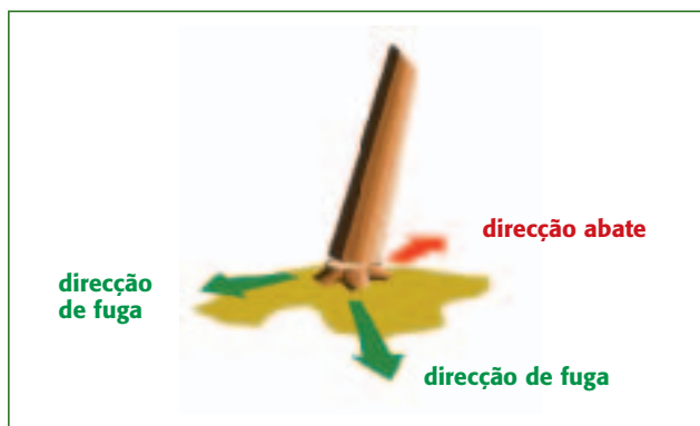
Figura 13 – Direcção de fuga do operador após o abate
