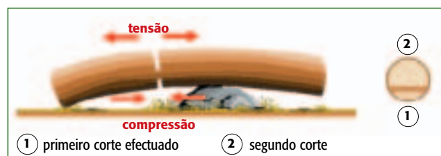
Figura 27 – Toragem: forças de tensão do lado superior do tronco
