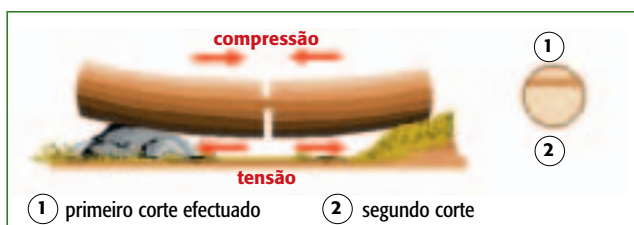
Figura 26 – Toragem: forças de tensão do lado inferior do tronco
