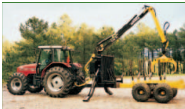
Figura 33 – Tractor agrícola adaptado ao trabalho florestal com reboque e grua
