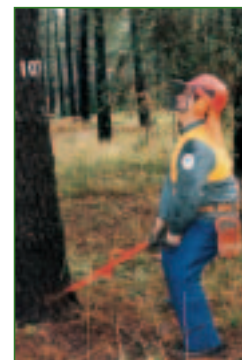
Figura 15 – Postura correcta do operador na utilização da panca
