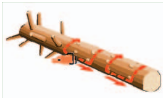
Figura 23 – Corte de ramos do lado inferior: tronco estável sem contacto com o solo
