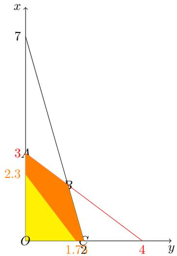
(c) A solução óptima é o vértice  $B$  com o valor da função objectivo de 115.3.
