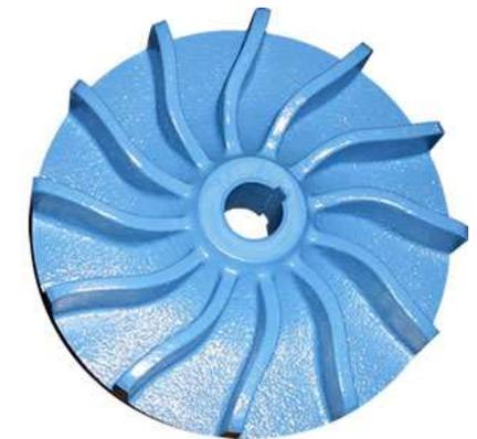
Os rotores abertos e semi-abertos são usados na bombagem de líquidos viscosos ou com partículas sólidas em suspensão (menor probabilidade de obstrução das pás)
