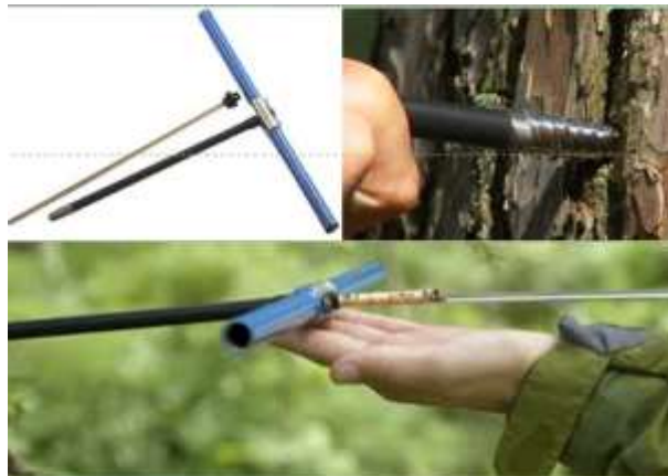
Verrumadas para análise de tronco parcial
