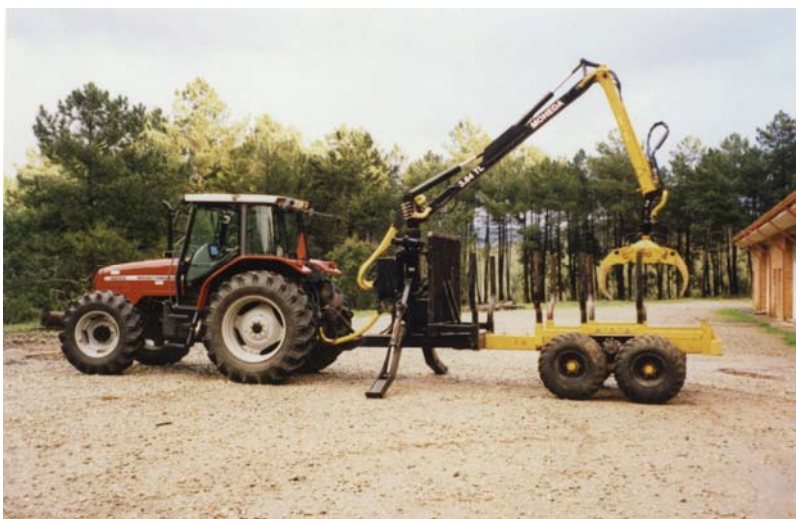
Trator agrícola adaptado ao trabalho florestal com reboque florestal e grua
