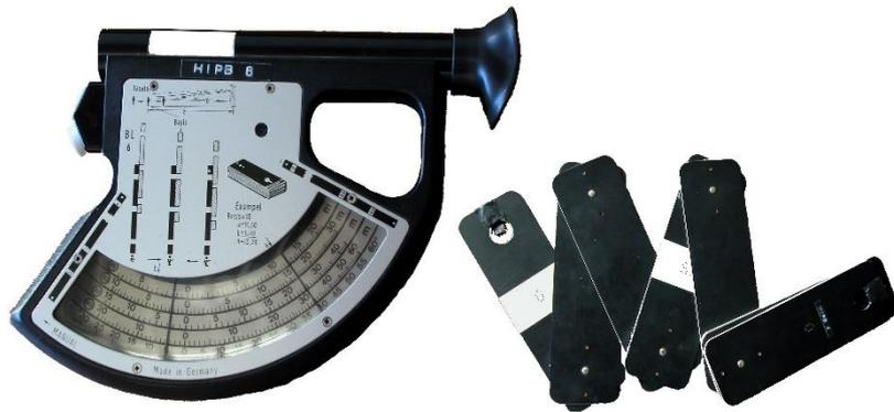
**Figura 33. Exemplo de hipsómetro de *Blume-Leiss***
