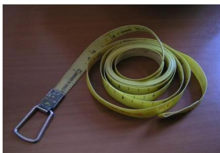
**Fig.20. Exemplo de uma Fita de Diâmetros**
