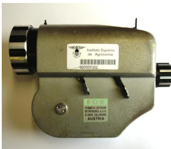
**Figura 35. O telerelascópio de Bitterlich**
