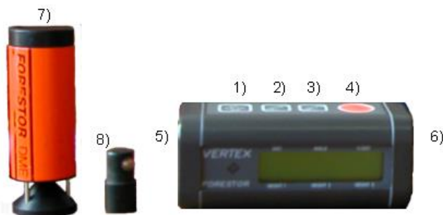
Figura 1 – O hipsómetro Vertex. Tecla ON/OFF (1), Tecla STEP (2), Tecla UNDO (3), Tecla LARANJA (4), sensor da temperatura (5), ocular (6), transponder (7) e sonda (8).
