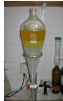
Lavagem do biodiesel com água.
