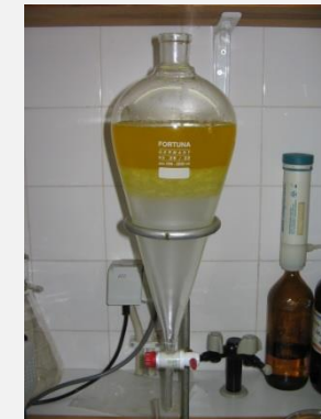
Lavagem do biodiesel com água.
