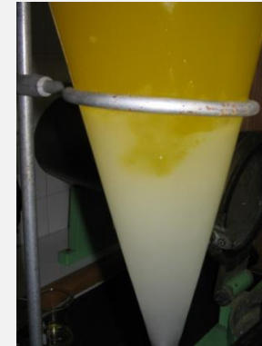
Lavagem do biodiesel com água.
