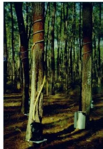
Medição da intercepção em pinhal, através da medição da: (a) precipitação sobre o pinhal, (b) precipitação que atinge o solo e (c) precipitação que escorre dos troncos (Fonte: David, 2018)
