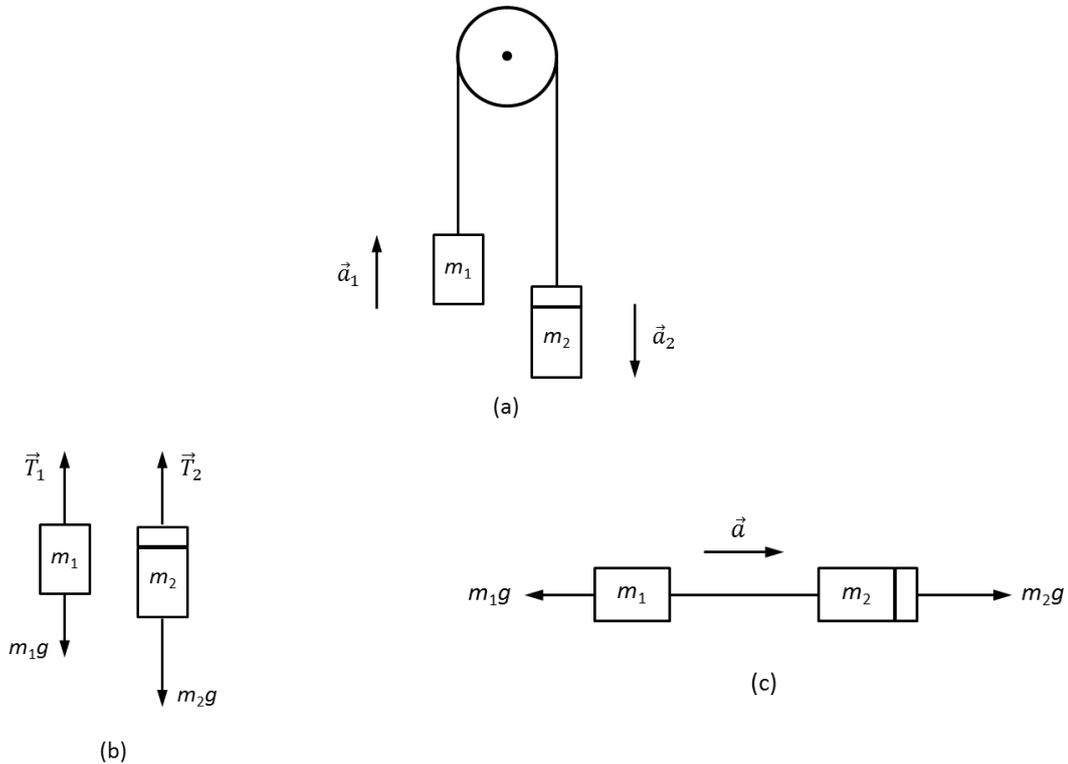
**Figura 5.2** Esquema de máquina de Atwood ideal. **(a)** Dois objectos ( $m_2 > m_1$ ) ligados por um fio inelástico, sem peso, sobre uma roldana sem atrito e com massa desprezável. **(b)** Diagrama de forças para ambos objectos. **(c)** Representação com um diagrama horizontal, já que a roldana apenas muda a direcção das forças em presença.
