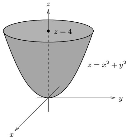
O volume  $V$  está limitado superiormente pela função constante  $z = 4$  e inferiormente pela função  $z = x^2 + y^2$ . A intersecção do parabolóide  $z = x^2 + y^2$  com o plano  $z = 4$  define circunferência  $x^2 + y^2 = 4$ . Daqui concluímos que a projecção de  $V$  no plano  $xOy$  é o círculo  $D = \{(x, y) : 0 \leq x^2 + y^2 \leq 4\}$ . Portanto o volume  $V$  é dado pelo integral
