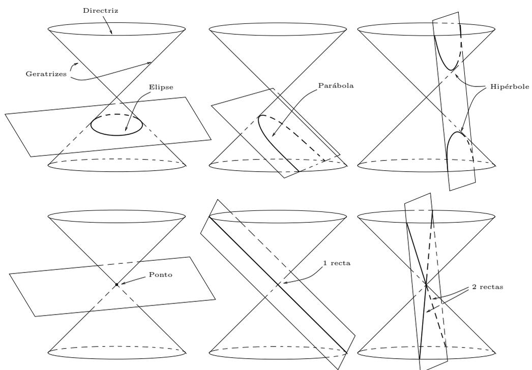
As elipses, parábolas e hipérbolas são designadas por *cônicas não degeneradas*. As restantes intersecções designam-se por *cônicas degeneradas* e ocorrem quando o plano passa pelo vértice da superfície cónica.
