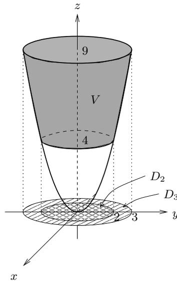
O volume de  $V$  obtém-se fazendo a diferença dos volumes dos sólidos  $V_1$  e  $V_2$ , sendo  $V_1$  [resp.  $V_2$ ] limitado superiormente pelo plano  $z = 9$  [resp.  $z = 4$ ] e ambos limitados inferiormente pelo parabolóide  $z = x^2 + y^2$ .
