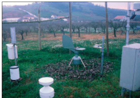
Fig. 27 – Estação meteorológica equipada com capta-esporos volumétrico, udómetro, sensor de período de humectação e sensor de temperatura do ar, na Sobrena, Cadaval
