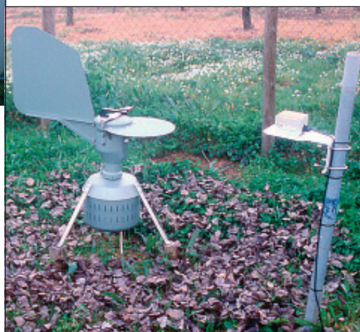
Fig. 27 – Estação meteorológica equipada com capta-esporos volumétrico, udómetro, sensor de período de humectação e sensor de temperatura do ar, na Sobrena, Cadaval
