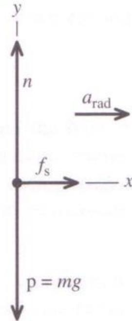
**Figura 5.33** (a) A situação. (b) Diagrama do corpo livre.
