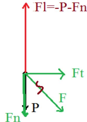
Para construir o diagrama do corpo livre consideram-se todas as forças que atuam sobre o corpo colocadas com origem num ponto que representa o corpo. Deste modo é fácil calcular a força resultante de todas as forças que atuam sobre o corpo
