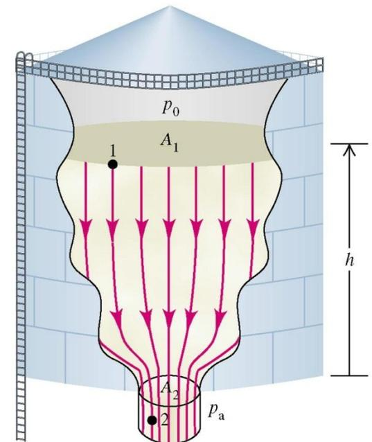
FIGURA 14.24 Esquema para calcular a velocidade de efluxo da gasolina que escoo pela parte inferior do tanque de armazenamento.
