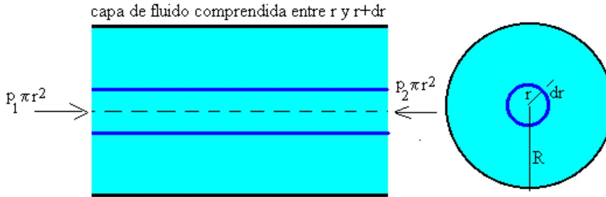
Isolemos no interior do fluido um cilindro de fluido de raio  $r$ . A força  $F$  é a diferença das forças resultantes da pressão exercida pela restante parte do fluido nas duas secções e a área é a superfície lateral do cilindro de raio  $r$ . Aplicando a eq (1) fica:
