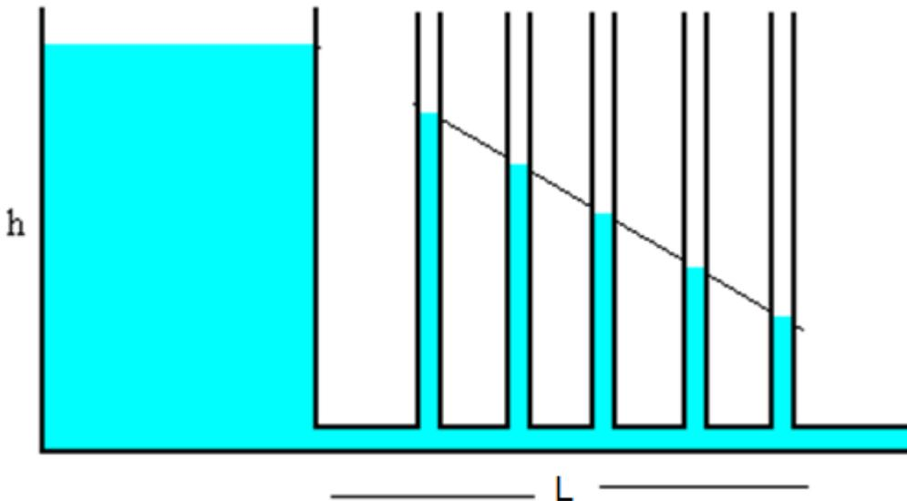
Na figura os tubos manométricos marcam alturas decrescentes, informando-nos das perdas de energia por atrito devido à viscosidade. Na saída, uma parte da energia potencial que tem qualquer elemento de fluido ao iniciar o movimento foi transformado integralmente em calor.
