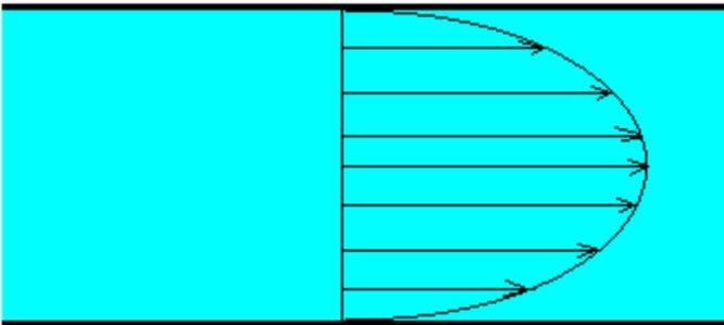
O escoamento tem portanto um perfil de velocidades parabólico, sendo a velocidade máxima no centro do tubo ( $r=0$ ).
