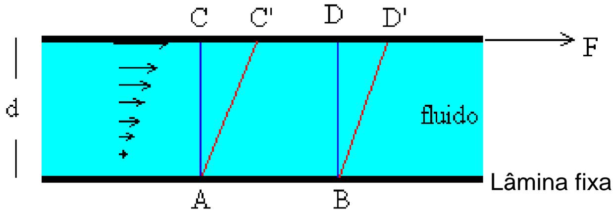
Na figura, é representado um fluido compreendido entre uma lâmina inferior fixa e uma lâmina superior móvel.
