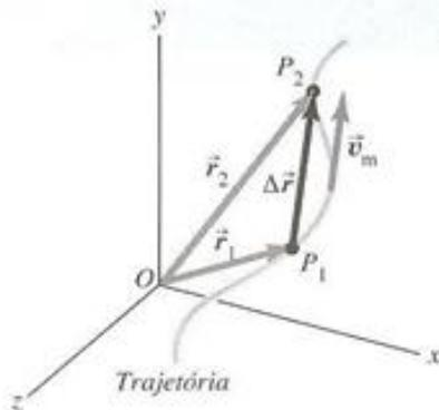
FIGURA 3.2 A velocidade média  $\vec{v}_m$  entre os pontos  $P_1$  e  $P_2$  possui a mesma direção e o mesmo sentido do vector deslocamento  $\Delta\vec{r}$ .
