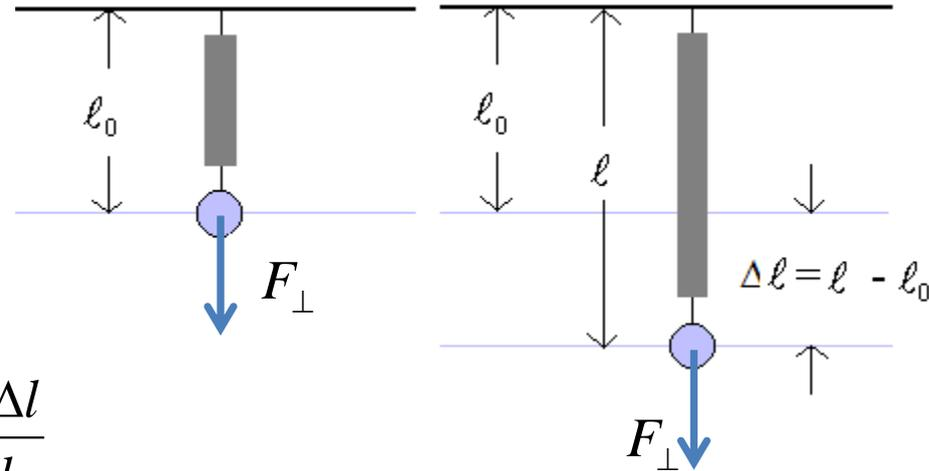
$$Y = \frac{\text{tensão de tração}}{\text{def. específica}} \Rightarrow Y = \frac{F_{\perp}/A}{\Delta l/l_0}$$
