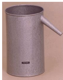
Recipiente para drenagem do líquido deslocado
