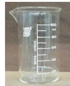
Copo para recolha do líquido deslocado
