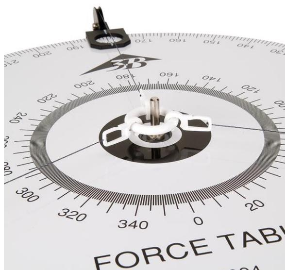
Figura 2 – Detalhe do anel na situação de equilíbrio pretendida.
