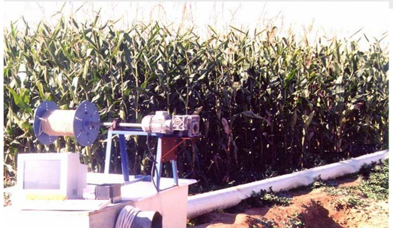
Figura 8 - Sistemas de Cabo-Rega com controlador: a) hidráulico; b) electrónico.
