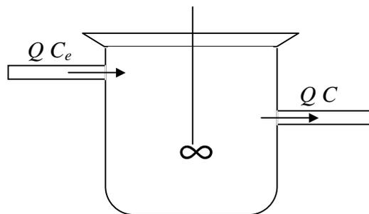
O balanço de massa ao tanque determina a igualdade entre a taxa de variação da quantidade do componente no interior do tanque ( $V \frac{dC}{dt}$ ) e a diferença entre as
