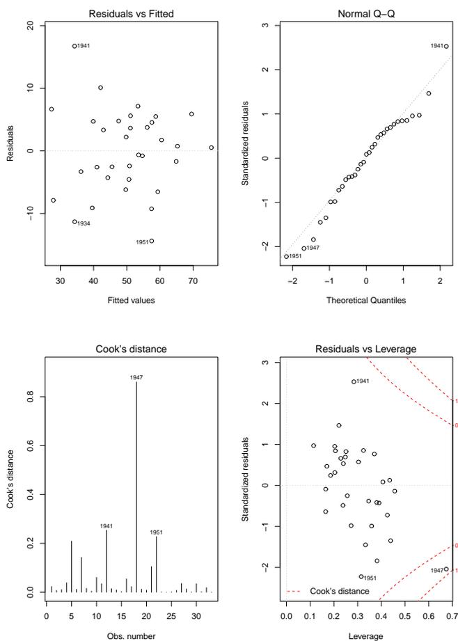
O gráfico de resíduos usuais *vs.* valores ajustados  $\hat{y}_i$  (no canto superior esquerdo) não apresenta qualquer padrão digno de registo, dispersando-se os resíduos numa banda horizontal. Assim, nada sugere que não se verifiquem os pressupostos de linearidade e de homogeneidade
