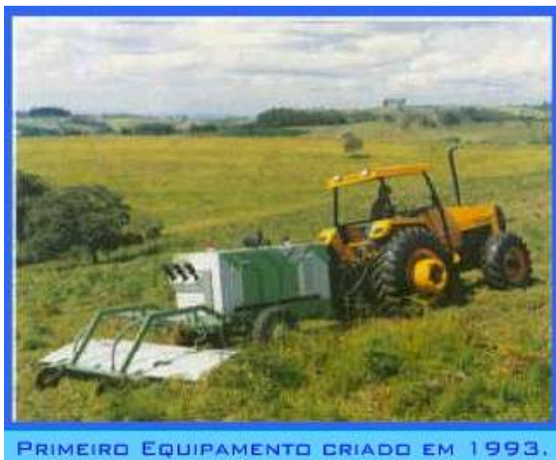
Fig.3 - Equipamentos, rebocados por trator, para descargas elétricas
