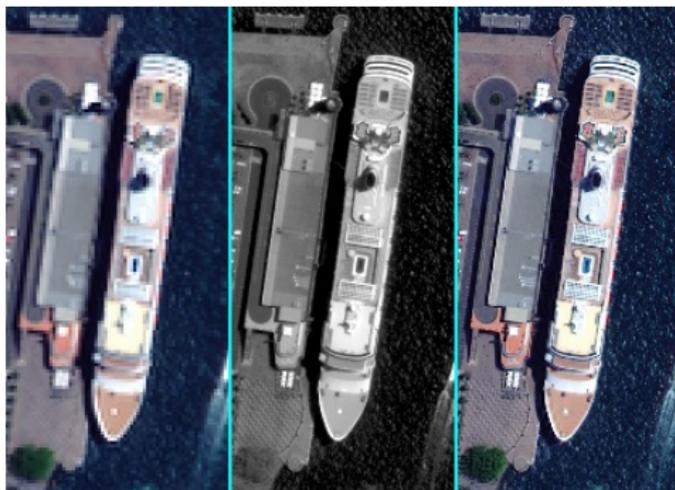
**Figura:** A resolução espacial das imagens multiespectrais Worldview é 1.84m (à esquerda). A resolução espacial das imagens pancromáticas Worldview é 46cm (ao centro). À direita está representada uma composição colorida usando um algoritmo de fusão da imagem pancromática com as imagens multiespectrais. <http://www.geoimage.com.au/>, 16.05.2012.
