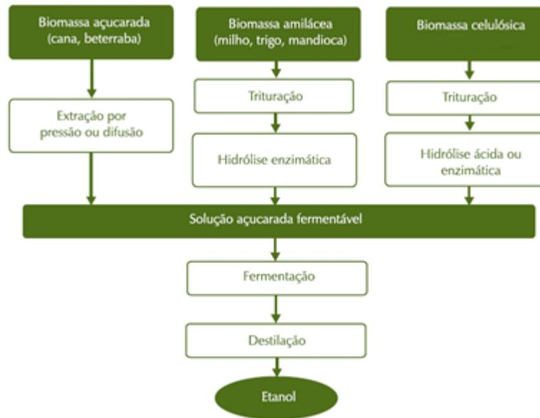
Figura 3.3. Diferentes rotas tecnológicas para a produção do etanol.
