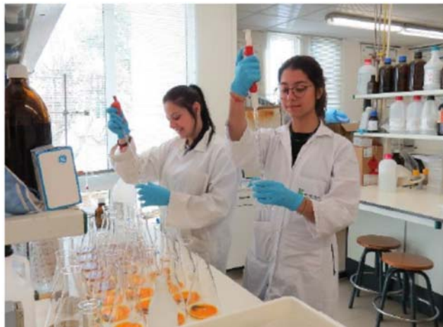
Figura 1: Processo de determinação da matéria orgânica do solo
